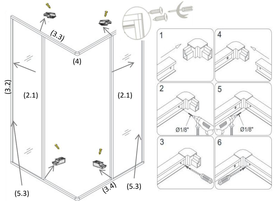
Siliconar los perfiles verticales (3.2) internamente y colocar los Vidrios fijos (2.1) en el borde posterior, presionando para encastrarlos en los perfiles C verticales. En el borde anterior sujetar el vidrio con los soportes L , atornillándolos sobre los rieles horizontal.
