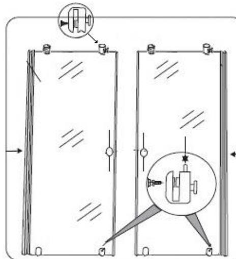
Colocar las puertas encastrando las ruedas en el Riel superior (3.3), y presionando el botón de las ruedas inferiores introducir las en el Riel inferior (3.4).
