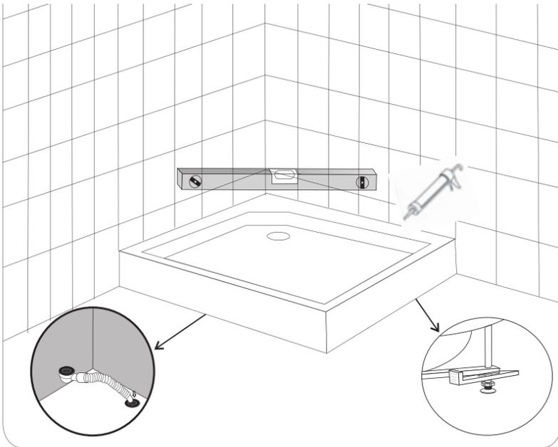
Ubicar el receptáculo en el ángulo y dejarlo nivelado ajustando las patas roscadas, evitando movimientos.
