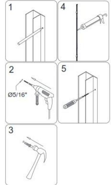
Presentar los Perfiles U Verticales sobre las esquinas del receptáculo nivelando y encuadrando, marcar los orificios para hacer las perforaciones con mecha de 6 mm, colocar los tarugos, previamente poner silicona detrás de los perfiles U y luego amurarlos a las paredes
