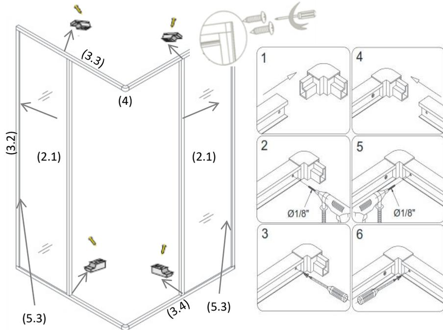
Colocar los Vidrios fijos, con el burlete U siliconado en el borde posterior, presionando para encastrarlos en los perfiles C verticales. En el borde anterior sujetar el vidrio con los soportes L , atornillándolos sobre los rieles horizontal.
