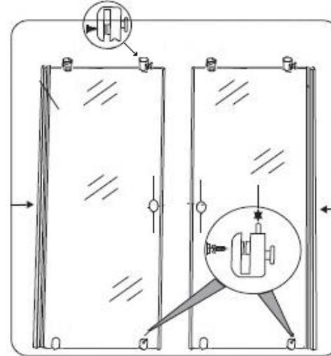
Colocar las puertas encastrando las ruedas dobles en el Riel superior, y presionando el botón de las ruedas inferiores introducirlas en el Riel inferior.
