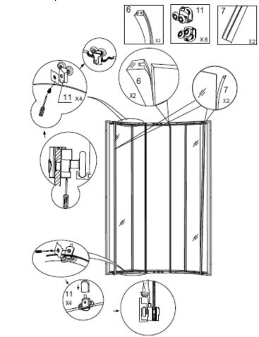
Colocar las puertas encastrando las ruedas en el Riel superior, y presionando el botón de las ruedas inferiores introducirlas en el Riel inferior.
