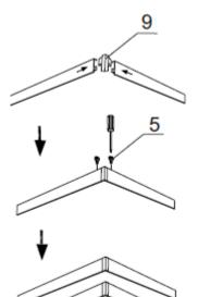
Armar los perfiles horizontales con las punteras atornillando ambos elementos
