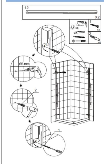
Medir y amurar en la pared los perfiles verticales, siliconando entre la pared y el perfil para lograr mayor firmeza.
